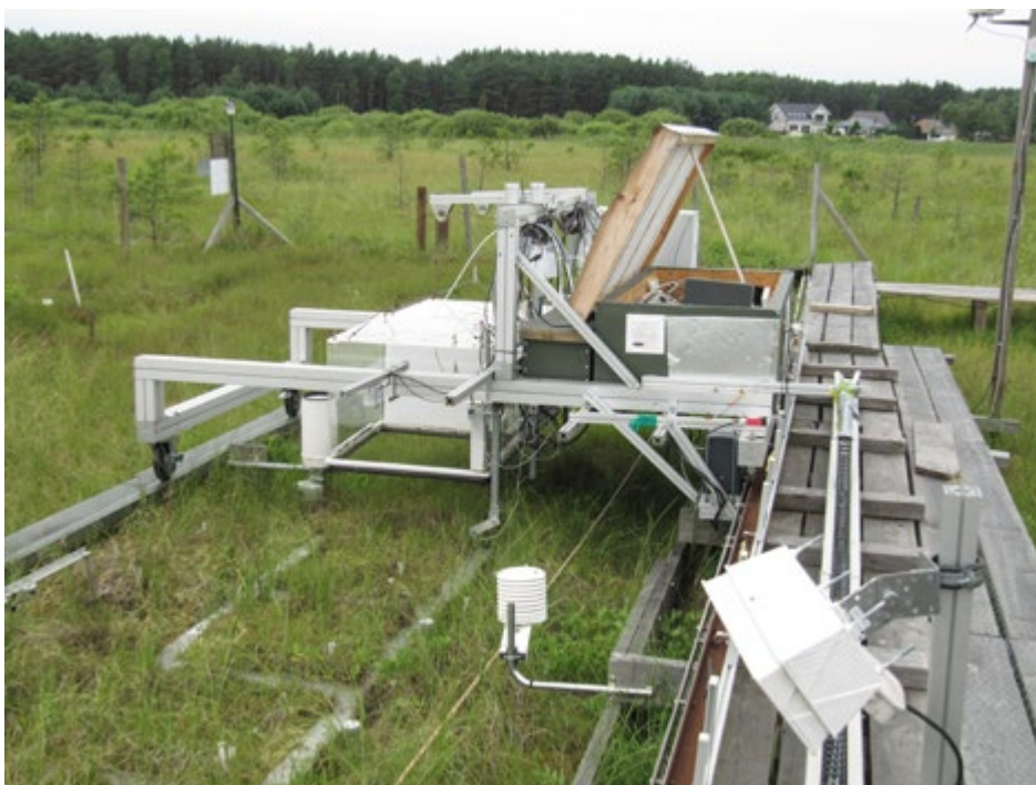
Fot. 87. Automatyczna stacja pomiarowa bilansu gazów cieplarnianych, eksperyment manipulacyjny na Torfowisku Rzecińskim (fot. J. Kujawa-Pawlaczyk).
