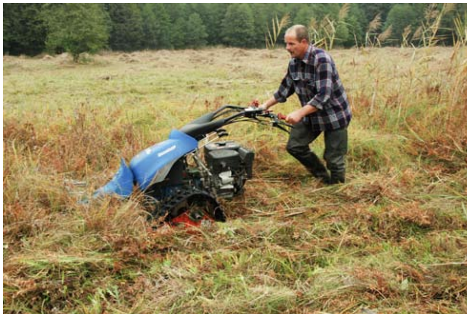
Fot. 62. Traktor jednoosiowy – kosiarka listwowa na gumowych gąsienicach, doskonale radząca sobie w najtrudniejszych warunkach na silnie uwodnionym torfowisku, to bardzo dobre i efektywne rozwiązanie techniczne. Umożliwia wykoszenie w tym samym czasie powierzchni ok. 4-5 razy większej, niż w przypadku kosi spalinowej, zużywając przy tym ok. 2/3 mniej paliwa i nie uszkadza roślinności (fot. R. Stańko).
