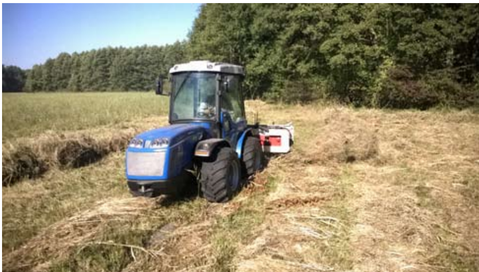
Fot. 63. Przygotowanie do zbioru i zbiór skoszonej biomasy za pomocą lekkich traktorów ogrodniczych nawet z zastosowaniem szerokich bądź podwójnych kół jest możliwe tylko w przypadku części torfowisk, w pozostałych jedynym rozwiązaniem pozostaje zbiór ręczny (fot. R. Stańko).
