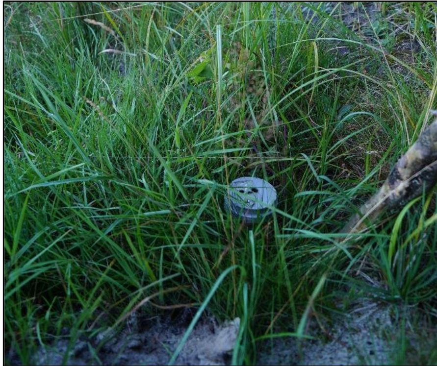
Fot. 49. Piezometr P4 w pobliżu torfowiska (fot. M. Przybylski)
