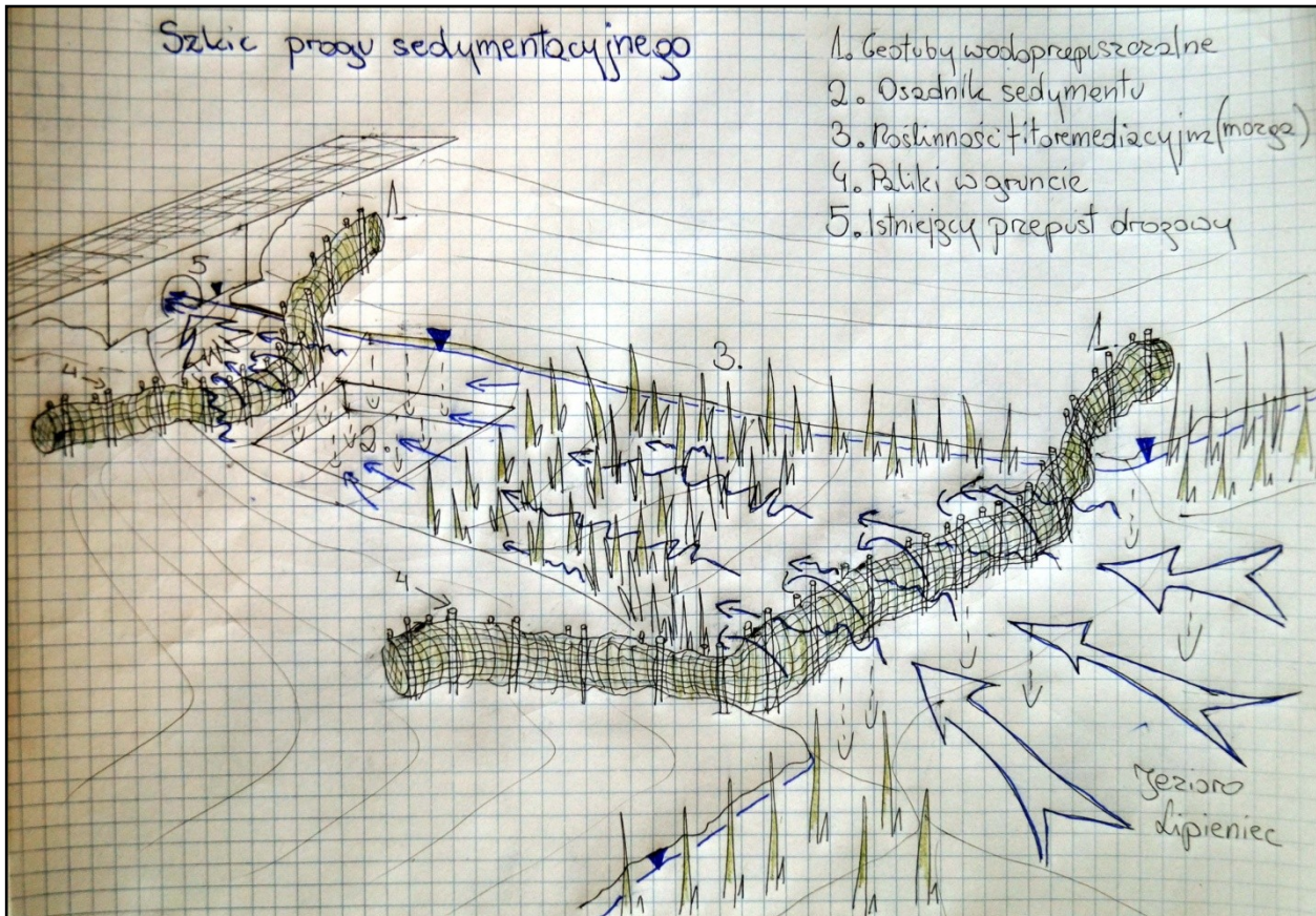
Ryc. 46. Szkic odręczny progu sedymentacyjnego z przegradami filtracyjnymi.
