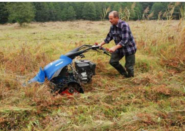
Fot. 8. Traktor jednoosiowy – kosiarka listwowa na gumowych gąsienicach, doskonale radząca sobie w najtrudniejszych warunkach na silnie uwodnionym torfowisku to bardzo dobre i efektywne rozwiązanie techniczne. Umożliwia wykoszenie w tym samym czasie powierzchni ok. 4-5 razy większej niż w przypadku kosi spalinowej zużywając przy tym ok. 2/3 mniej paliwa oraz nie uszkadza roślinności (fot. R. Stańko).
