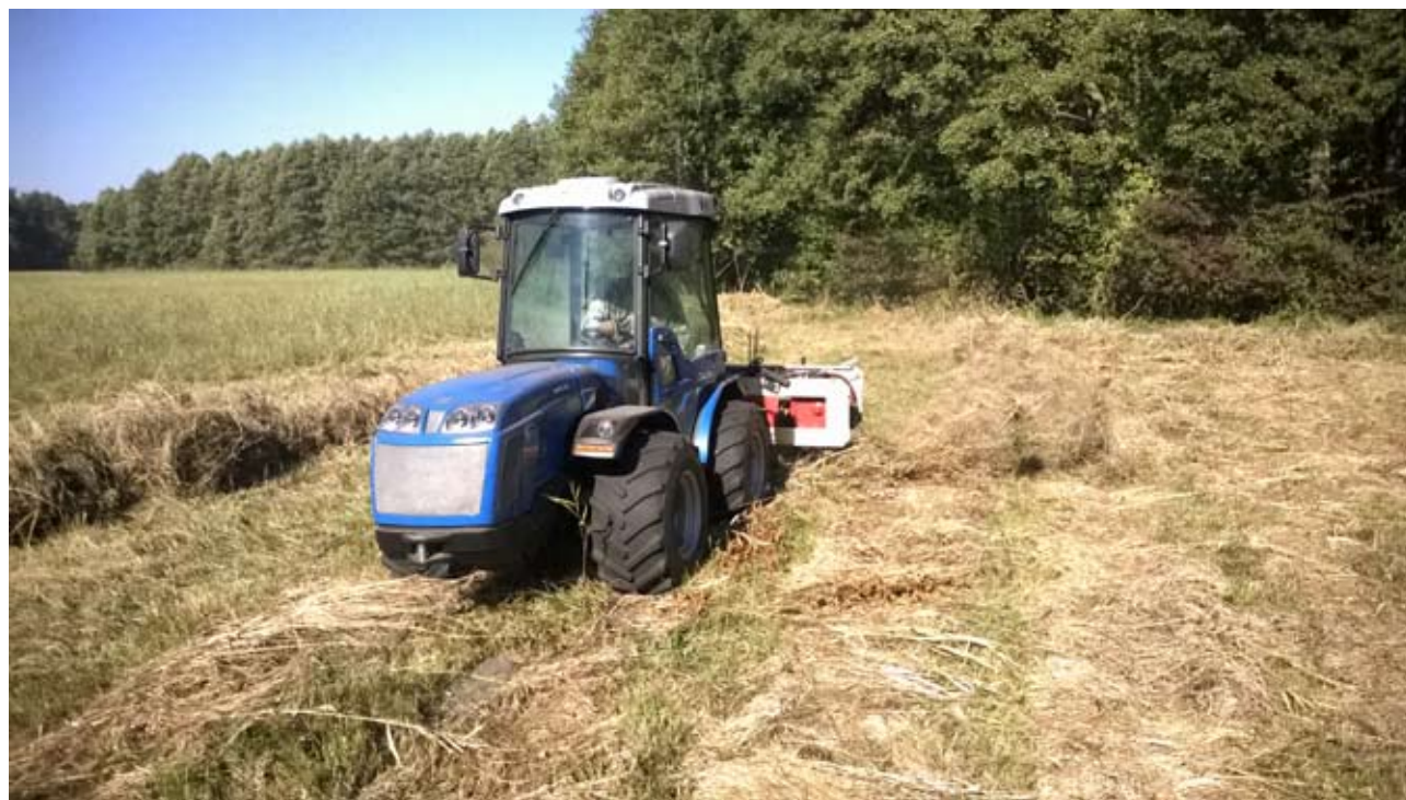
Fot. 9. Przygotowanie do zbioru i zbiór skoszonej biomasy za pomocą lekkich traktorów ogrodniczych nawet z zastosowaniem szerokich bądź podwójnych kół jest możliwe tylko w przypadku części przesuszonych torfowisk, w pozostałych jedynym rozwiązaniem pozostaje zbiór ręczny (fot. R. Stańko).
