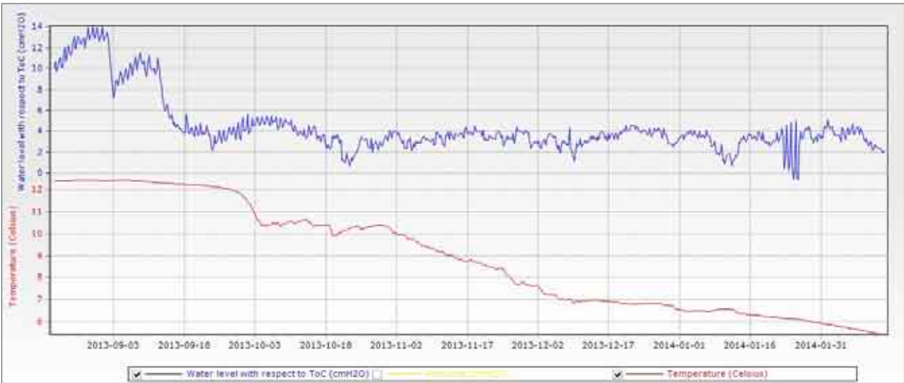
Ryc. 90. Zapis z limnigrafu automatycznego obrazujący spektakularną poprawę stanu uwilgotnienia torfowiska „Płonia-Żydowo” po zablokowaniu przepływu w rowach melioracyjnych.
