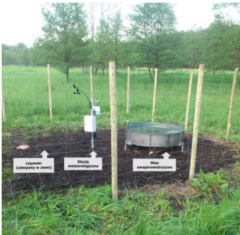
Zdj. 7. Część sprzętu do monitoringu hydrologicznego – komplet zamontowany w terenie – obiekt Kosobudki
