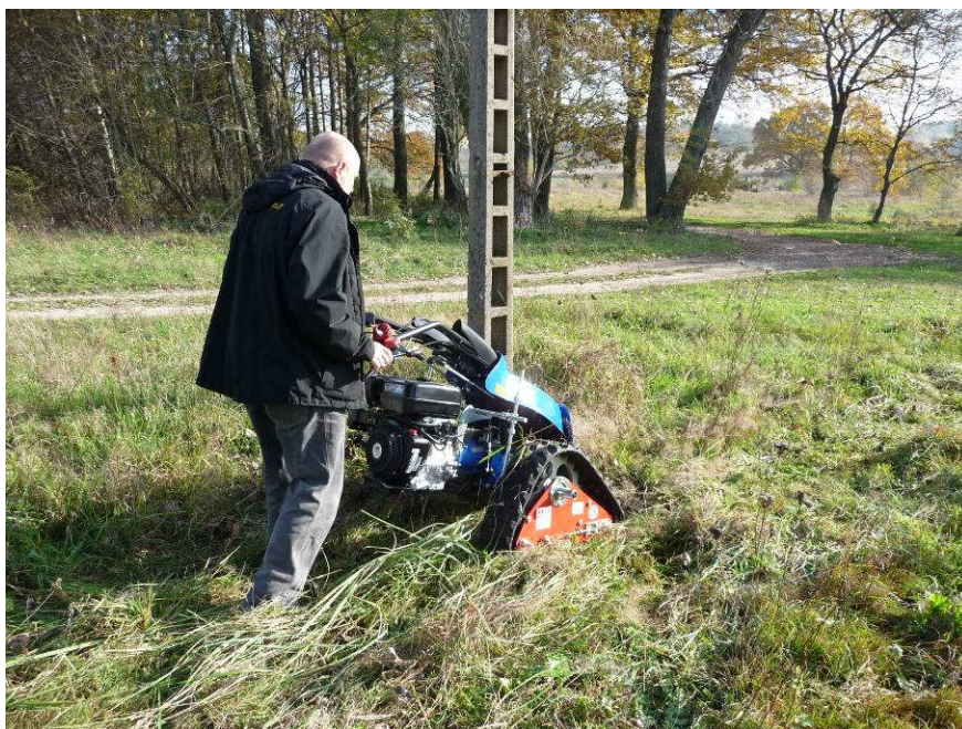
Zdj. 9. Sprzęt do koszenia zakupiony w ramach projektu – ciągnik jednoosiowy na gąsienicach
