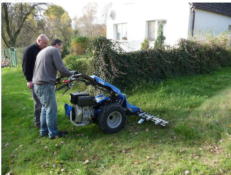
Zdj. 10. Sprzęt do koszenia zakupiony w ramach projektu – ciągnik jednoosiowy na kołach typu „balony”
